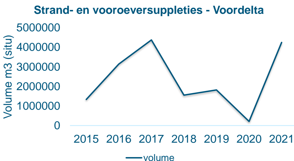
Figuur 4-1 Overzicht van de gesuppleerde volumes zand in de Voordelta in de periode 2015 - 2021
